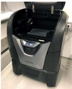
Mit der Anschaffung eines hochpräzisen 3D-Druckers Agilista-3200W der Firma Keyence erweitert der Lehrstuhl FAPS den Technologiebereich für additive Fertigung im Forschungslabor in Erlangen. Mit der auf einem Multimaterial-InkJet-Verfahren basierenden Fertigungsanlage ist es unter anderem möglich, kleine und komplexe Bauteile aus transparentem Kunststoff mit hoher Präzision und Geschwindigkeit herzustellen.
