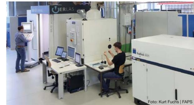
Für die Erforschung laserbasierter Prozesse zum Fügen von Kupferwerkstoffen steht dem Lehrstuhl für Fertigungsautomatisierung und Produktionssystematik eine neue Versuchszelle zur Verfügung. Die auf die Anforderungen des Lehrstuhls zugeschnittene Sondermaschine wurde in enger Abstimmung mit dem Unternehmen ERLAS Erlanger Lasertechnik GmbH realisiert.
