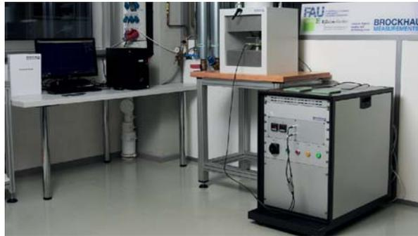
Zur Klassifizierung von hartmagnetischen Materialien, wie Hartferrit, AlNiCo, SmCo-, Nd/PrFeCo, steht ab sofort eine geeignete Messanlage vom Typ Brockhaus Hystograph HG 200 zur Verfügung. Die Anlage ermöglicht die Aufzeichnung von Hysteresekurven bei verschiedenen Temperaturen bis zu 200 °C. Durch die maximale Feldstärke von 2400 kA/m können auch hochkoerzitive Materialien vermessen werden.
